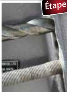
Retirez l'écrou et forez un trou extra pour le boulon de stabilisation
