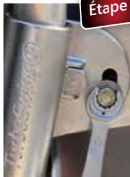
Dévissez le boulon de réglage, trimez le moteur tout à fait vers le bas, et installez le Turboswing® dans la position désirée, ensuite revissez le boulon de réglage
