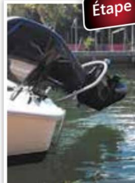
Vérifiez que la fonction autotrim fonctionne et collez la bande de protection sur la queue du moteur
