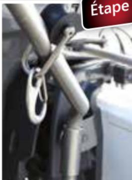
Installez la barre dans les deux supports de fixation. Trimmez le moteur si nécessaire. Les supports doivent savoir bouger indépendamment l'un de l'autre
